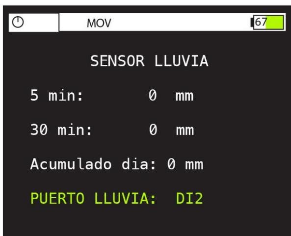
Esta pantalla muestra el acumulado del sensor de lluvia para dos periodos de tiempo, el más corto de 5 minutos se actualiza muy rápidamente, y es útil para la verificación durante la puesta en marcha de la estación.
