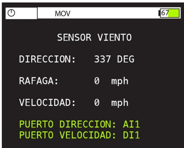
Esta pantalla muestra la información del anemómetro de la estación. El anemómetro está compuesto de dos sensores, uno mide la dirección del viento, y el otro mide la velocidad.
