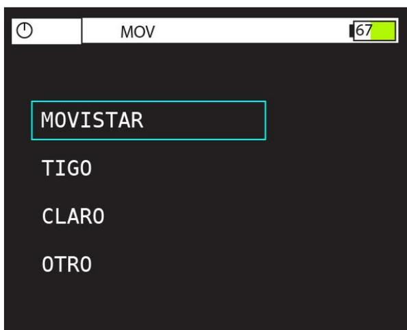
Verifique que el operador seleccionado corresponde a la Simcard instalada en el equipo, si se selecciona incorrectamente el equipo no podrá conectarse a la red y obtener la conectividad a internet necesaria para reportar los datos recopilados a la web.
